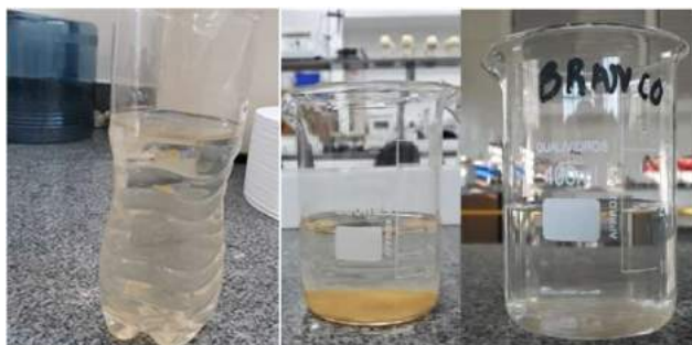
Figura 1: Amostra de água coletada do rio Paraíba do Sul (à esquerda) e amostras de água do rio Paraíba do sul sobre tratamento com coagulante regenerado (centro) e com coagulante comercial à direita.
