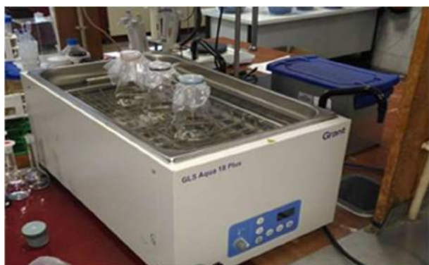
Figura 2 - Ensaio Chapelle em banho Maria com água durante 16 horas
