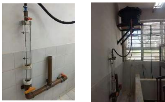
Figura 2. Equipamento utilizado no ensaio de permissividade.
