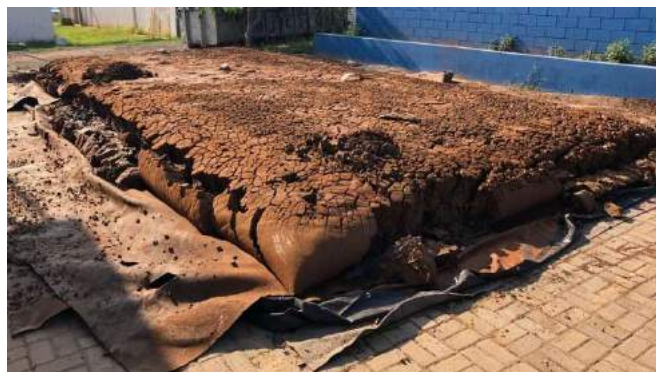
Figura 4. Tubo geotêxtil com lodo in natura após o período de consolidação, aberto e pronto para ser removido.
