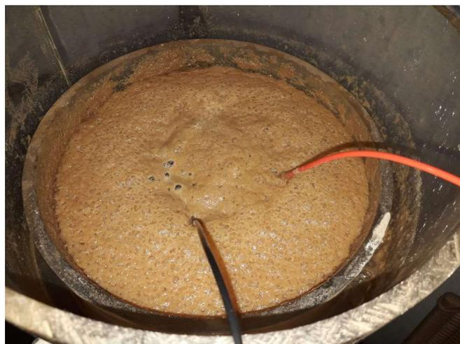
Comparando a quantidade de lodo gerado pelo SEFF com a quantidade de água tratada por ele, conclui-se que para as voltagens de 10, 20 e 30 V, se tem, respectivamente, uma geração de 0,01; 0,06 e 0,15 % em volume. Dessa forma, a qualidade do tratamento quanto aos parâmetros de potabilidade da água tratada deve justificar a escolha da maior voltagem, já que o aumento de lodo gerado é latente, ao se comparar com a menor voltagem empregada.
